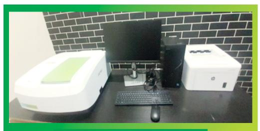
4 UV/Visible Spectrometer LAMBDA 365 Perkin Elmer
